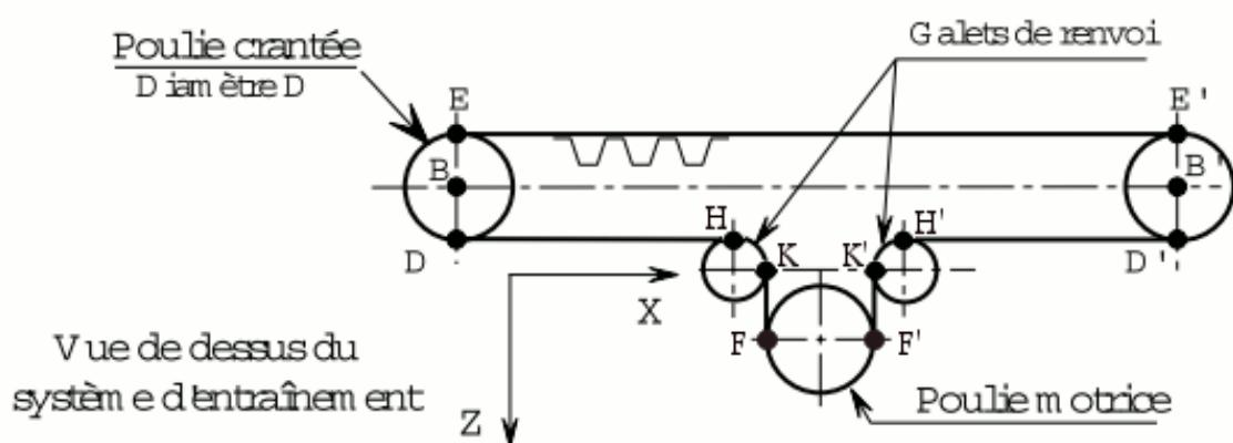
Les poulies servant à l'entraînement des deux vis sont de même diamètre primitif  $D_p$  que la poulie fixée à l'extrémité de l'arbre de sortie du réducteur. Le rapport de transmission de l'ensemble poulies courroie crantée est donc 1 ( $D_p = 2 R_p = 100 \text{ mm}$ ).
